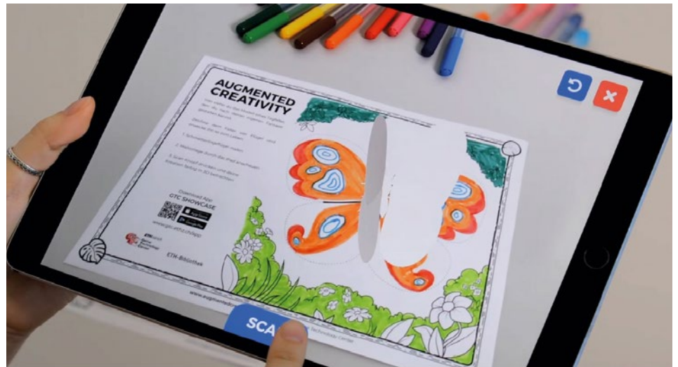
Abb. 2: AR-Malbuch-App des GTC – Die App detektiert die physische Schmetterlings-Malvorlage als Marker und zeigt das entsprechende 3-D-Modell an. (© GTC)
